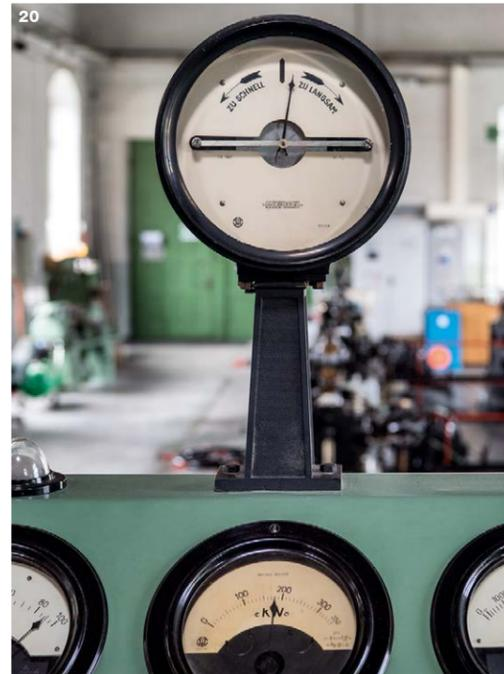
19+20 Originale Bedieneinrichtungen von 1894: Turbinenregler und Steuerpult.
