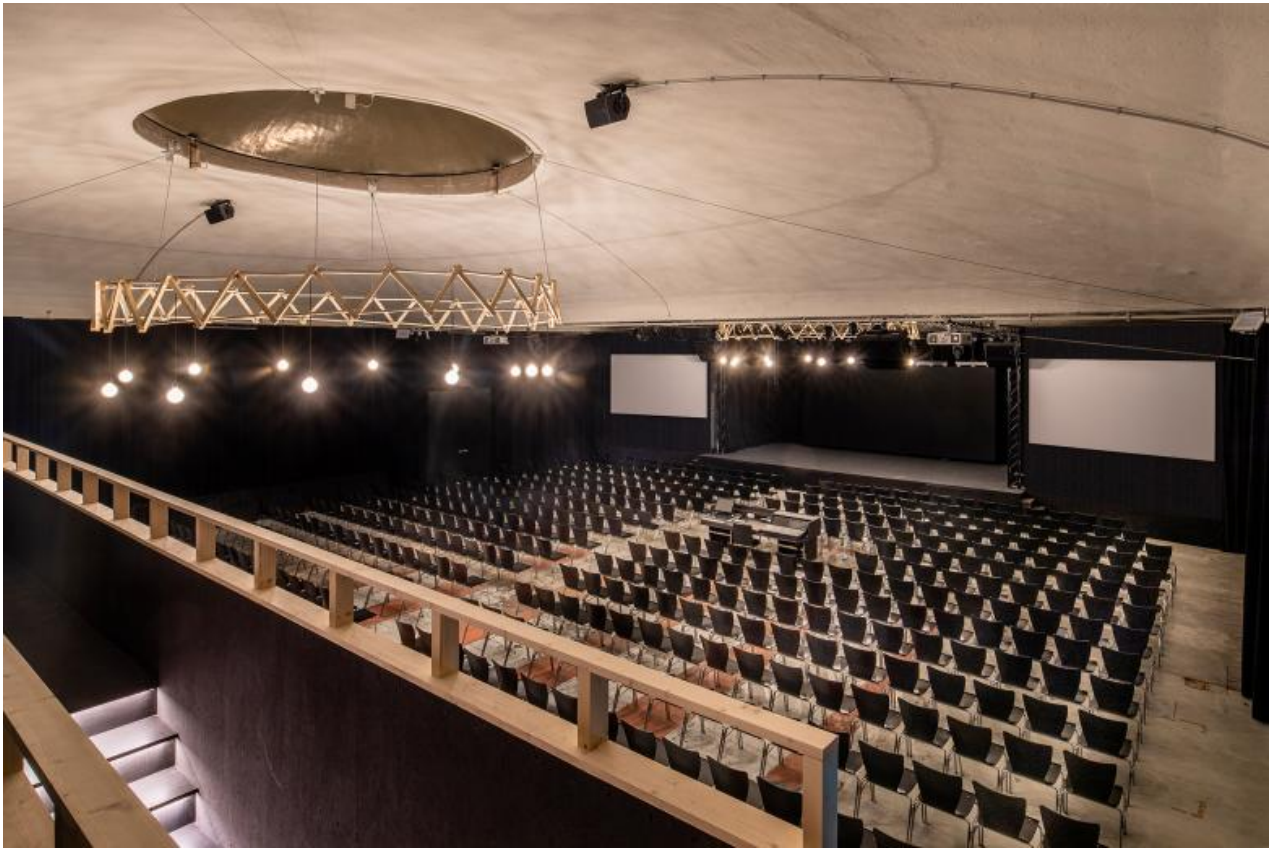
Der Saal verfügt über 600 Sitz- und 1'000 Stehplätzen unter zwei Isler-Schalen zu je 14 mal 20 Metern. (Foto: Christian Helmle)
